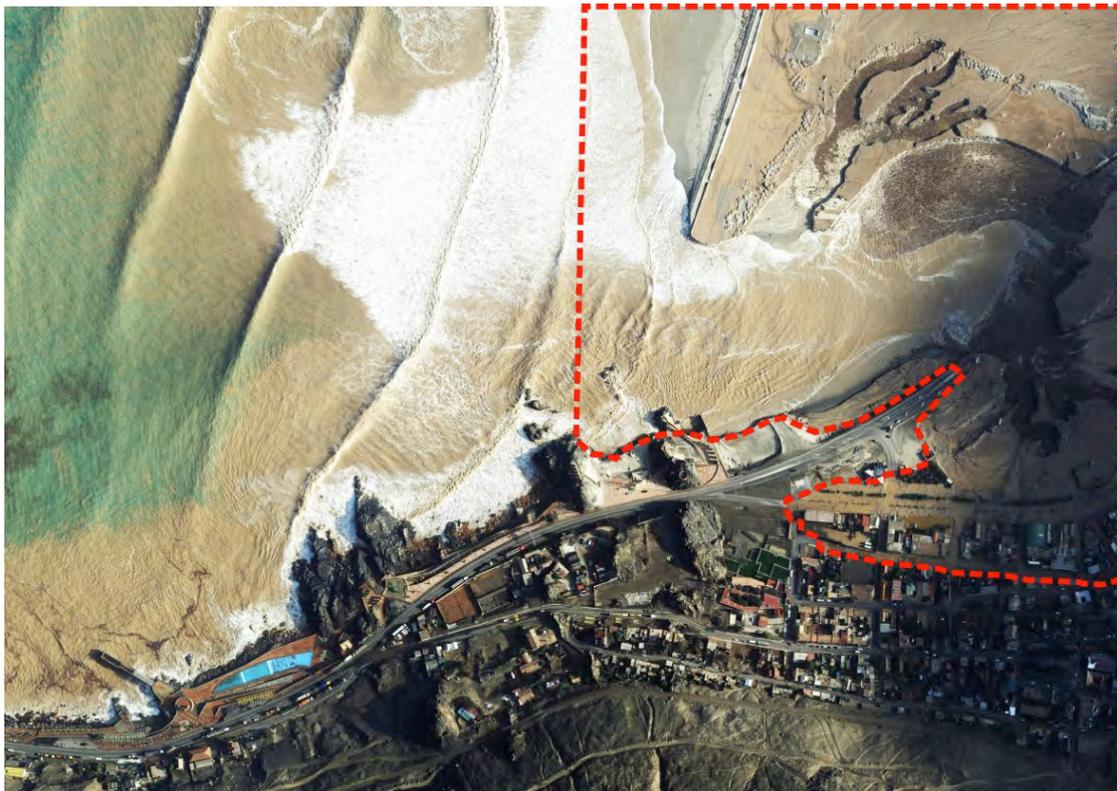
Figura 21. Inundación y socavones en zona centro sur de Chañaral. Fuente: Elaboración propia en base a foto post evento de S.A.F (26.03.2015)
